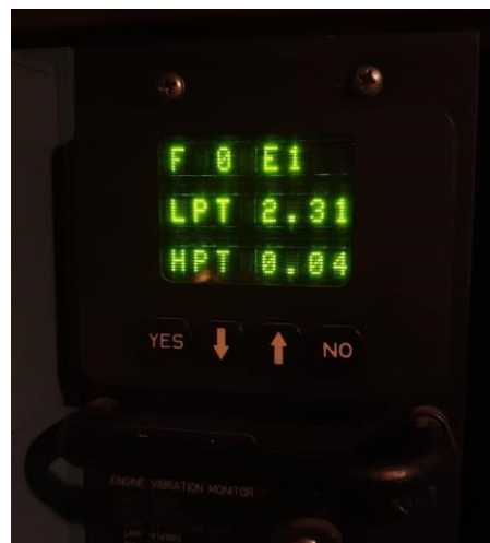
Gambar 7. Data-data yang terekam oleh Airborne Vibration Monitoring (AVM)
