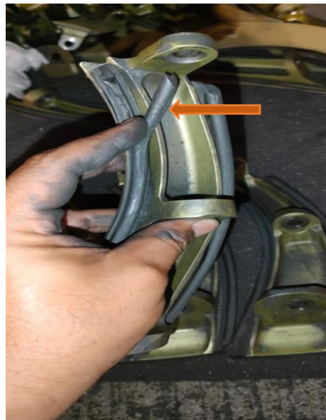
Gambar 7.b. (Panah Orange) Fanblade Platform signifikan Unbonded lip seals pada area concave
