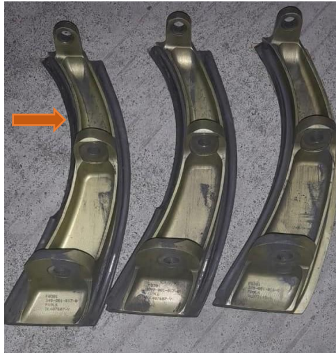
Gambar 7.a. (Panah Orange) Fanblade Platform signifikan missing lip seals pada area concave dan convex
